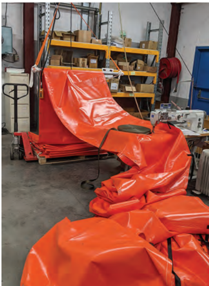
Fabrication d'un barrage de 50 mètres
