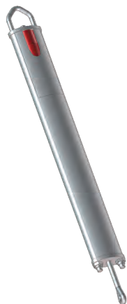
Amortisseur d'énergie alu/inox à oeil Installé à une extrémité de la ligne de vie, il permet de réduire les efforts sur la structure en cas de chute
